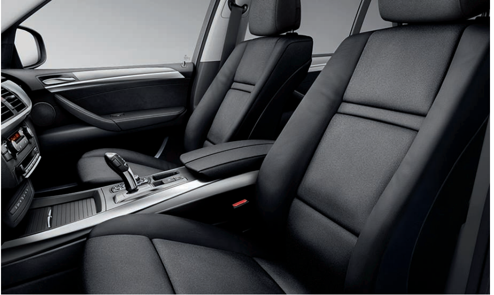
■ Seriensitz mit manueller Einstellung der Längsposition, Sitzneigung, Kopfstützenhöhe und -neigung sowie elektrischer Einstellung für Sitzhöhe und Lehnenneigung.
