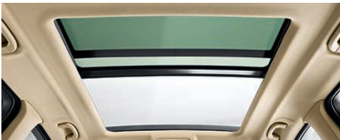
□ Panorama Glasdach mit großzügigem Öffnungs- und Durchsichtsbereich sowie geschwindigkeitsabhängigem Windabweiser. Beide Glashälften lassen sich per Tiptasten elektrisch anheben, der vordere Teil verfügt zusätzlich über Schiebefunktion, elektrischen Schwebehimmel (Sonnenschutz) sowie Komfortöffnung/-schließung mit Einklemmschutz.
