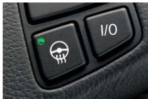
□ **Lenkradheizung:** erwärmt auf Knopfdruck innerhalb kurzer Zeit den Lenkradkranz – besonders angenehm im Winter (erhältlich in Verbindung mit Lederlenkrad, Sport-Lederlenkrad und M Lederlenkrad).
