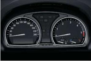
■ **Instrumententafel** mit Analoginstrumenten und roter Durchlichtbeleuchtung, Tacho mit LC-Display für Kilometer- und Tageskilometerzähler sowie Bordcomputer, Drehzahlmesser mit integrierter Tankuhr und Kühlmittelthermometer.
