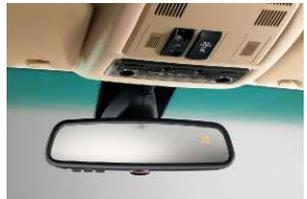
□ **Innenspiegel** mit digitaler Kompassfunktion (rechts in das Spiegelglas integriert).
