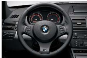
□ **M Lederlenkrad:** sehr griffig durch den dickeren Lenkradkranz. Mit den integrierten Multifunktionstasten können während der Fahrt Radio, CD-Laufwerk und, sofern vorhanden, Telefon bedient werden.
