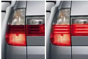
■ **Zweistufige Bremsleuchten** helfen nachfolgenden Fahrzeugen, Ihre Bremsituation besser einschätzen zu können: Im Falle einer Notbremsung vergrößert sich die Leuchtfläche der Bremsleuchten. So kann der nachfolgende Verkehr sofort ein leichtes Abbremsen von einer Vollbremsung unterscheiden – für noch mehr Fahrsicherheit.
