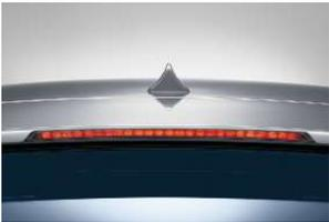
■ **Bremssleuchte**, dritte, für mehr Sicherheit hochgesetzt und in den in Wagenfarbe lackierten Dachspoiler integriert.
