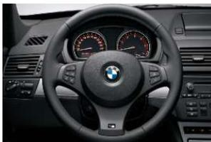
**M Lederlenkrad:** sehr griffig durch den dicken Lenkradkranz. Mit den integrierten Multifunktionsknöpfen können während der Fahrt Radio, CD-Laufwerk und Telefon (optional) bedient werden.
