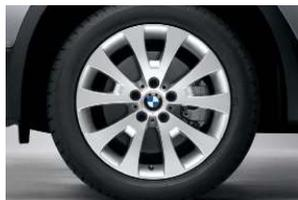
□ **BMW Leichtmetallrädern** V-Speiche 206, mit Mischbereifung, vorn 8 J x 18 Zoll, Bereifung 235/50 R 18, hinten 9 J x 18 Zoll, Bereifung 255/45 R 18.
