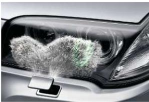
■ **Scheinwerfer-Waschanlage** ermöglicht bei jeder Witterung eine optimale Leuchtkraft der Scheinwerfer. Parallel zur Frontscheibe werden bei eingeschaltetem Licht auch die Scheinwerfergläser automatisch gereinigt (in Xenon-Licht enthalten).
