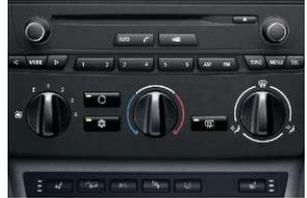
■ **Klimaanlage**, inkl. Mikrofilter, ermöglicht zu jeder Jahreszeit ein komfortables Innenraumklima, Luftmengenregelung und Luftverteilung manuell einstellbar.
