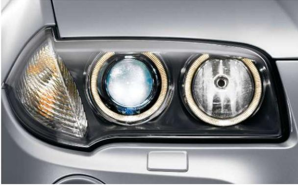
□ **Xenon-Licht für Abblend- und Fernlichtfunktion**, inkl. Scheinwerfer-Waschanlage und automatischer Leuchtweitenregulierung, leuchtet die Fahrbahn nachts, bei schlechter Witterung oder Sicht deutlich besser aus.
