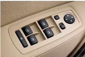
■ **Fensterheber**, elektrisch, Zug-Druckschalter, inkl. Mautfunktion, Einklemmschutz und Komfortschließung rundum.
