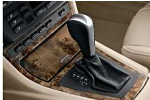
□ **6-Gang Automatic Getriebe Steptronic**, mit Adapter Getriebebesteuerung (AGS), Shift-/Interlock; die Schaltung ermöglicht sehr komfortable und sportliche Gangwechsel – für ein Höchstmaß an Fahrdynamik (Serie für X3 xDrive35d, nicht erhältlich für X3 xDrive20i und X3 xDrive18d).
