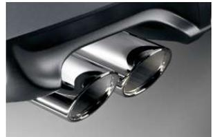
■ **Auspuffendrohr**: Die Abgasanlage verfügt über zwei Auspuffendrohre mit sportlichen Chromblenden (die Modelle X3 xDrive20i, xDrive18d und xDrive20d kennzeichnen jeweils ein Edelstahl-Endrohr).
