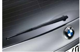
■ **Heckscheibenwischer** mit Intervallschaltung.
