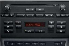
□ **Klimaautomatik**, inkl. AUC und Solarsensor, sorgt schnell für Ihr Wunschklima und hält eine vorgewählte Temperatur konstant; die Automatische Umluft Control (AUC) schützt vor Schadstoffen von außen, indem ab einer bestimmten Konzentration auf Umluftbetrieb geschaltet wird (Serie für X3 xDrive35d).
