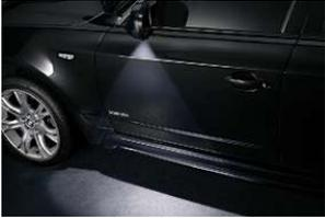
□ **Lichtpaket** enthält Vorfeldbeleuchtung in den Außenspiegeln, Ausstiegsbeleuchtung in allen Türen unten, Fußraumleuchten sowie für die X3 Modelle xDrive20i, xDrive25i, xDrive18d und xDrive20d beleuchtete Make-up-Spiegel und Leseleuchten hinten.
