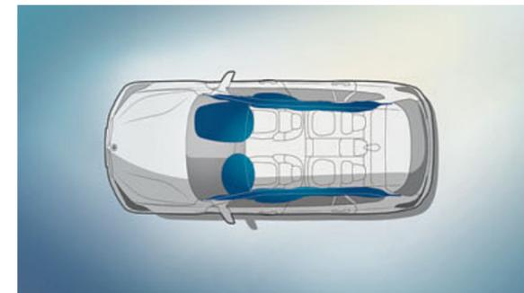
■ Die **Airbags für Fahrer und Beifahrer** sind integraler Bestandteil der optimal aufeinander abgestimmten Sicherheitskomponenten in einem BMW. Insgesamt bieten sechs Airbags gezielten Schutz: Fahrer- und Beifahrerairbag, die Kopfairbags für die gesamte seitliche Fensterfläche sowie die Seitenairbags in den Vordersitzlehnen.
