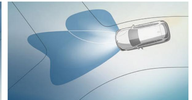
□ Der **LED-Scheinwerfer** mit Abbiegelicht bietet eine tageslichtähnliche Ausleuchtung der Fahrbahn für Abblend- und Fernlicht.
