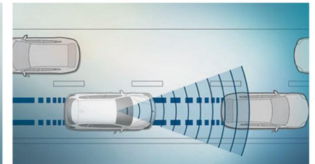
■ Die **Auffahrwarnung mit City-Anbremsfunktion** warnt vor drohenden Kollisionen und bremst im Notfall sogar selbsttätig. Zusätzlich erkennt die Speed Limit Info Tempo-Beschränkungen. Diese können durch Betätigen einer Wippe am Lenkrad automatisch in den manuellen Geschwindigkeitsbegrenzer übernommen werden.<sup>2</sup>
