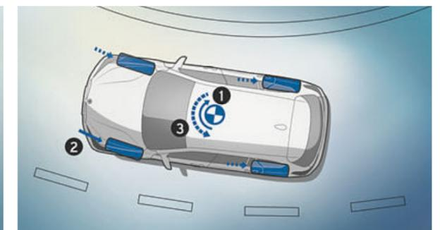
■ Die **Cornering Brake Control (CBC)** unterstützt den Fahrer durch eine asymmetrische Bremsdruck-Regelung beim Bremsen in Kurven.
