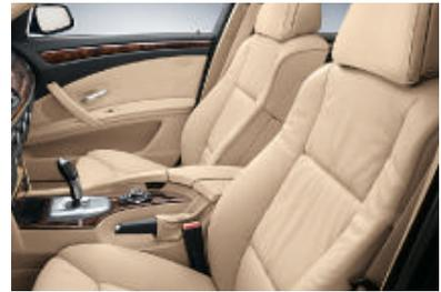
□ **Komfortsitze** für Fahrer und Beifahrer, elektrisch verstellbar, inkl. Komfortkopfstützen (äußere Auflagefläche verstellbar) mit Aktivfunktion; Verstellmöglichkeit des oberen Lehnensegments, der Lehnenbreite, der Oberschenkelauflage und der Kopfstützenhöhe; inkl. Lordosenstütze und Memory-Funktion für Fahrer- und Beifahrerseite, Außenspiegel und elektrisch verstellbare Lenksäule.
