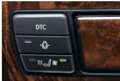
□ **Aktive Sitzbelüftung** sorgt im Sommer durch eine kühle und angenehme Sitztemperatur für deutlich mehr Komfort. Ventilatoren in Sitzfläche und Rückenlehne blasen Luft durch die perforierten Sitzbezüge. Für Fahrer- und Beifahrersitz (nur in Verbindung mit Leder Nasca, nicht in Verbindung mit Sportsitzen).
