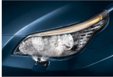
□ **Scheinwerfer-Waschanlage** ermöglicht bei jeder Witterung eine optimale Leuchtkraft der Scheinwerfer. Parallel zur Frontscheibe werden bei eingeschaltetem Licht auch die Scheinwerfergläser automatisch gereinigt (nur in Verbindung mit Xenon-Licht).
