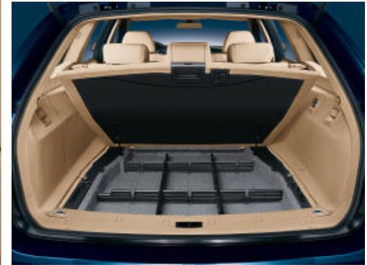
Das abschließbare Staufach ist durch vier variable Trennelemente flexibel nutzbar.
