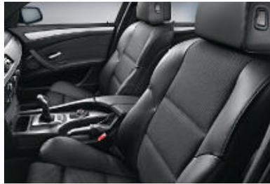
□ **Sportsitze** für Fahrer und Beifahrer, hoch ausgeformte Sitzwangen sorgen für optimalen Seitenhalt in jeder Fahrsituation. Die Sitzhöhe und die Lehnenneigung sind elektrisch verstellbar, die Sitzneigung, die Längsposition und die Oberschenkelauflage manuell.
