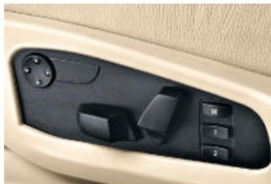
□ **Sitzverstellung, elektrisch**, für Fahrer- und Beifahrersitz. Sämtliche Sitzebenen und die Kopfstützenhöhe sind elektrisch verstellbar, inkl. Memory-Funktion für Fahrersitz, Außenspiegel und Lenksäule sowie Bordsteinautomatik für Beifahreraußenspiegel (Serie für 550i und 535d).
