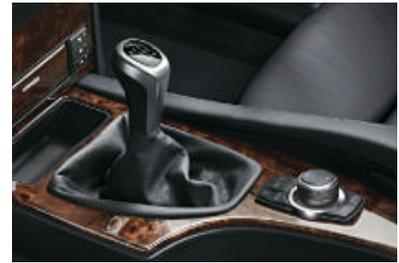
■ **6-Gang Schaltgetriebe** ermöglicht eine sehr sportliche Fahrweise. Es ist leichtgängig, perfekt abgestuft und glänzt mit exakten, kurzen Schaltwegen. Durch das enger gestufte Getriebe mit dem zusätzlichen sechsten Gang können Sie die sportliche Motorcharakteristik – Ihrem Fahrstil entsprechend – noch individueller nutzen (nicht für 535d).
