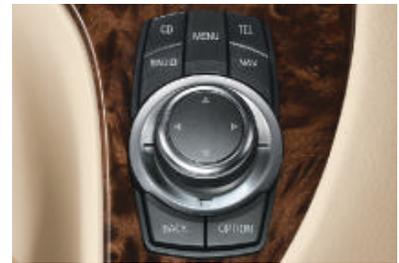
■ **Controller**. Mit diesem Dreh-/Druckknopf lassen sich verschiedene Funktionen über das Control Display ansteuern. Vier unterschiedliche Menüs sind auch per Direktwahltasten aufrufbar: CD, Radio, Navigation und Telefon. Die drei weiteren Tasten Menu, Option und Back erleichtern die Bedienung.
