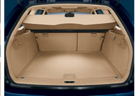
Das Abdeckrollo fährt automatisch nach oben, wenn Sie die Heckklappe oder die Heckscheibe öffnen.
