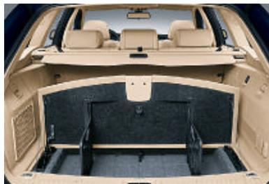
□ **Ablagenpaket** für einen multifunktional nutzbaren und noch variableren Gepäckraum. Zur Ausstattung gehören ein mehrfach unterteiltes Staufach unter dem Gepäckraumboden sowie zwei klappbare Abtrennungen zum Fixieren unterschiedlich großer Gegenstände. Weitere Umfänge: Spanngurte an den Seitenwänden, Multifunktionshalter und ein auf der linken Seite angeordnetes Ablagenetz für kleinere Dinge.
