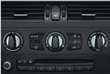
■ **Klimaautomatik**, inkl. Mikrofilter, für Ihr Wunschklima zu jeder Jahreszeit, automatische Temperatur- und Luftmengenregelung, Klappenprogramm und Fondbelüftung; Anzeige und Einstellungen über das Control Display.
