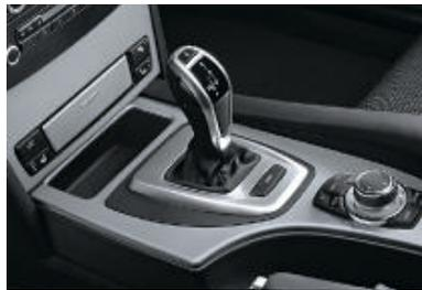
□ **6-Gang Sport-Automatic Getriebe Steptronic** verfügt für eine besonders dynamische Fahrweise über eine Sportcharakteristik mit kürzeren Schaltzeiten und ist mit Schaltwippen am Sport-Lederlenkrad ausgestattet (erhältlich für 530i, 550i, 530d und 535d, nicht in Verbindung mit xDrive).
