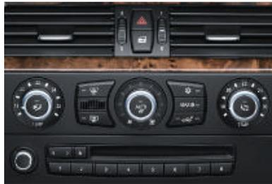
□ **Klimaautomatik mit erweitertem Umfang**, inkl. Automatischer Umluft Control (AUC), Solar- und Beschlagsensor, autom. Temperaturregelung und Luftverteilung (getrennt für Fahrer und Beifahrer) sowie Luftmengenregelung; Anzeige und Einstellungen über das Control Display. Ausstattung umfasst auch die verschiebbare Armauflage mit klimatisiertem Ablagefach (Serie für 550i und 535d).
