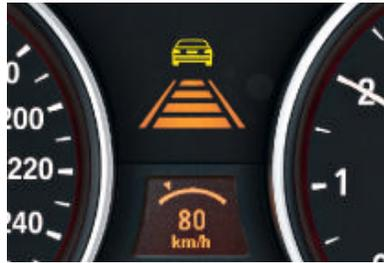
□ **Aktive Geschwindigkeitsregelung mit Stop&Go-Funktion.** Fahrerassistenzsystem für erhöhten Komfort und aktive Sicherheit im Kolonnenverkehr. Kombiniert Geschwindigkeits- mit aktiver Sicherheitsabstandsregelung bis zum Stillstand – bei Folgefahrten mit automatischem Wiederanfahren in typischen Stop-and-go-Situationen.
