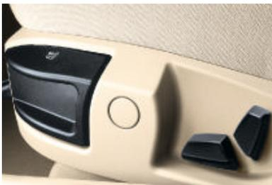
■ **Sitzverstellung, teilelektrisch**, für Fahrer- und Beifahrersitz, elektrische Funktion für Sitzhöhen- und Lehnenverstellung, manuelle Funktion für Längsposition und manuelle Neigungsverstellung auf der Fahrerseite.
