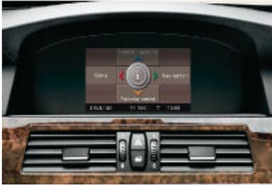
■ **Control Display** (6,5 Zoll, in Farbe) zur Darstellung der Funktionen, die per Controlller gesteuert werden (z. B. Bordcomputer oder Radio).
