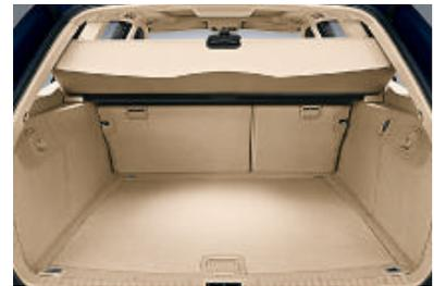
■ **Abdeckrollo, inkl. Trennnetz:** Beim Betätigen der Heckklappe bzw. -scheibe fährt das ausgezogene Rollo per Komfortöffnung nach oben – für ein bequemes Be- und Entladen des Gepäckraumes. Das Trennnetz schützt bei starkem Bremsen vor in den Fahrgastraum fallenden Gegenständen.
