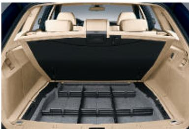
■ **Staufach** unter dem abschließbaren Ladeboden sichert kleinere Gegenstände. Die steckbaren Trennelemente erlauben dabei eine variable Nutzung.
