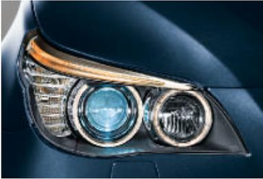
□ **Xenon-Licht für Ablend- und Fernlichtfunktion**, inkl. automatischer Leuchtweitenregulierung, Tagfahrlicht über Leuchtringe.
