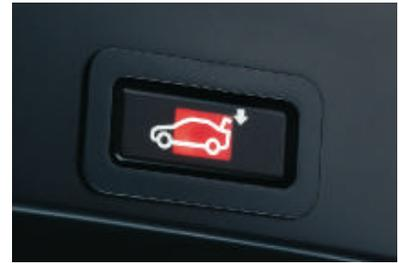
□ **Heckklappenbetätigung, elektrisch:** Die Heckklappe lässt sich per Fernbedienung automatisch öffnen und über den Taster in der Griffleiste schließen. Das Öffnen geschieht elektrohydraulisch. Beim Schließen der Heckklappe senkt sich das Abdeckrollo automatisch ab. Die Höhenarretierung ist per iDrive einstellbar.
