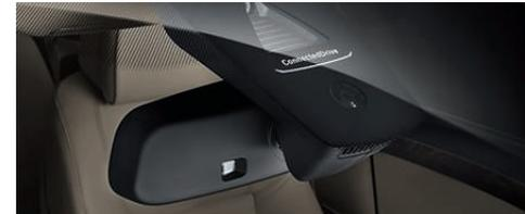
■ **Regensensor** inkl. Fahrlichtautomatik garantiert Ihnen optimale Sicht auch bei Regen und einsetzender Dunkelheit: Je nach Regenstärke steuert er die Intervallzeiten der Scheibenwischer und aktiviert bei Bedarf automatisch das Abblendlicht.
