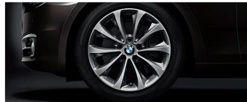
■ **19" Leichtmetallräder Turbinenstyling 452** mit Mischbereifung, Größe vorn 8,5 J x 19, Bereifung 245/45 R 19, Größe hinten 9,5 J x 19, Bereifung 275/40 R 19.
