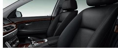
■ **Seriensitz** für Fahrer und Beifahrer bietet elektrisch verstellbare Sitzhöhe und Lehnenneigung. Beim Fahrersitz ist zudem die Sitzneigung ebenfalls elektrisch verstellbar. Sitzlängspositionierung und Kopfstützenhöhe werden manuell eingestellt.
