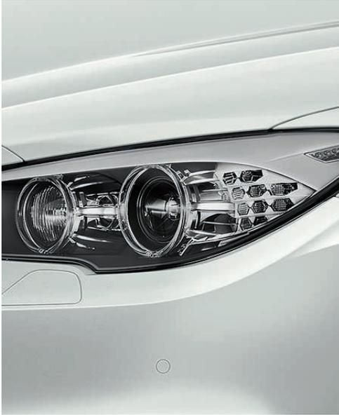
■ **Xenon-Licht** für Abblend- und Fernlichtfunktion umfasst Scheinwerfer-Waschanlage, Akzentleuchte und Blinker in LED-Technik, automatische Leuchtweitenregulierung sowie Park-, Stand- und Tagfahrlicht über vier LED-Leuchtringe.
