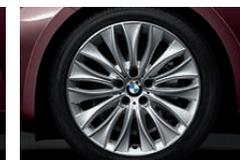
□ 20" Leichtmetallräder Vielspeiche 459 mit Mischbereifung, Größe vorn 8,5 J x 20, Bereifung 245/40 R 20, Größe hinten 10 J x 20, Bereifung 275/35 R 20.
