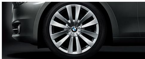
□ **20" Leichtmetallräder Doppelspeiche 253** mit Mischbereifung, Größe vorn 8,5 J x 20, Bereifung 245/40 R 20, Größe hinten 10 J x 20, Bereifung 275/35 R 20.
