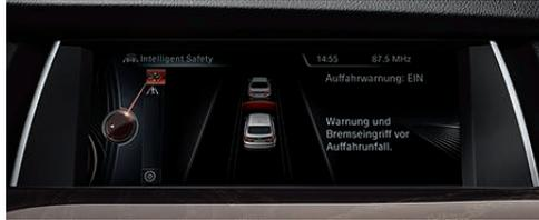
□ **Driving Assistant** kombiniert die kamerabasierten Systeme Spurverlassenswarnung und Auffahrwarnung. Ab einer Geschwindigkeit von ca. 70 km/h warnt das System bei ungewolltem Verlassen der Fahrspur durch leichtes Vibrieren am Lenkrad. Die Auffahrwarnung erkennt vorausfahrende Fahrzeuge und warnt bei drohender Kollisionsgefahr. Auch Fußgänger werden erkannt, sodass der Fahrer vor Kollisionen gewarnt wird und ggf. eine Bremsung eingeleitet wird.
