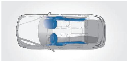
■ **Airbags** für Fahrer und Beifahrer sind integraler Bestandteil der optimal aufeinander abgestimmten Sicherheitskomponenten in einem BMW. Sechs Airbags bieten gezielten Schutz: Fahrer- und Beifahrerairbag, die Kopfairbags (Curtain) für vorn und hinten sowie die in den Vordersitzlehnen integrierten Seitenairbags.
