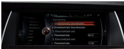
**Standheizung**, inkl. Timer-Funktion, für individuelles Temperieren des Fahrergastraums bei kälteren Temperaturen ohne Inbetriebnahme des Motors. So frieren Scheiben nicht zu und beschlagen nicht. Bei wärmeren Temperaturen sorgt die integrierte Standlüftung für einen angenehmen kühlen Innenraum.
