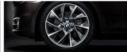
□ **20" Leichtmetallräder Turbinenstyling 457** mit Mischbereifung, Größe vorn 8,5 J x 20, Bereifung 245/40 R 20, Größe hinten 10 J x 20, Bereifung 275/35 R 20.
