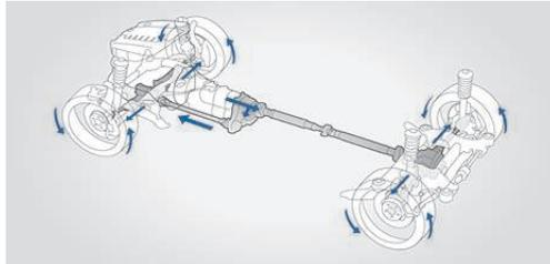
□ **BMW xDrive.** Das intelligente Allradsystem verteilt die Antriebskraft stufenlos und variabel auf die Vorder- und Hinterräder – für ein Plus an Traktion, Spurstabilität und Fahrsicherheit bei jeder Straßensituation.
