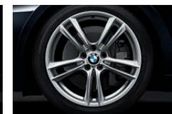
20" M Leichtmetallräder Doppelspeiche 303 M mit Mischbereifung, Größe vorn 8,5 J x 20, Bereifung 245/40 R 20, Größe hinten 10 J x 20, Bereifung 275/35 R 20.
