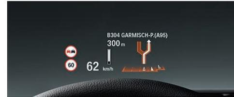
□ **BMW Head-Up Display, vollfarbig**, projiziert fahrelevante Informationen direkt ins Blickfeld des Fahrers (mit polarisierten Sonnenbrillen nur eingeschränkt erkennbar). Der Blick bleibt somit stets auf das Verkehrsgeschehen gerichtet. Angezeigt werden beispielsweise die aktuelle Geschwindigkeit, Navigationshinweise, Speed Limit Info inkl. Überholverbotsanzeige, Check Control-Meldungen und Infotainment-Hinweise.
