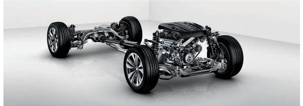
Die Sonderausstattung **Adaptive Drive** kombiniert die aktive Wankstabilisierung Dynamic Drive und die Dynamische Dämpfer Control. Sensoren messen permanent Geschwindigkeit, Lenkwinkel sowie Quer- und Längsbeschleunigung des Fahrzeugs. Auf Basis der Daten werden die Stabilisatoren- und Stoßdämpfereinstellungen reguliert. Sie sorgen so für präziseres Lenkverhalten und kürzere Bremswege bei gleichzeitig erhöhtem Fahrkomfort.
