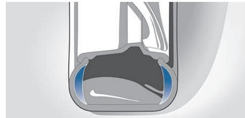
□ **Reifen mit Notlaufeigenschaften** sorgen durch verstärkte Flanken dafür, dass die Reifen selbst ohne Luftdruck nicht völlig einsinken und von der Felge springen können. So gelangen Sie mit Ihrem BMW auch im Falle einer Reifenpanne sicher zur nächsten Werkstatt.
