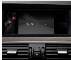
□ **BMW Night Vision mit Dynamic Light Spot** überträgt mit Hilfe einer Wärmebildkamera Bilder von Personen und Tieren in bis zu 300 Meter Entfernung direkt auf das Control Display. Darüber hinaus erkennt das System Personen und größere Tiere im Dunkeln und schon auf weite Distanz, leuchtet sie gezielt an und warnt über eine Anzeige in der Instrumentenkombination.
