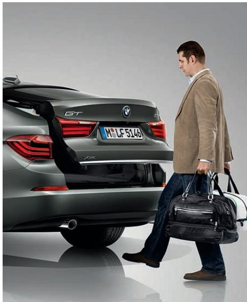
**Komfortzugang** ermöglicht den schlüssellosen Zugang zum Fahrzeug über Fahrertür, Beifahrertür und Gepäckraumklappe. Die Ausstattung umfasst zudem die Vorfeldbeleuchtung der Türaußengriffe vorn und hinten sowie das berührungslose Öffnen und Schließen der Heckklappe durch eine kurze Fußbewegung unter dem hinteren Stoßfänger.
