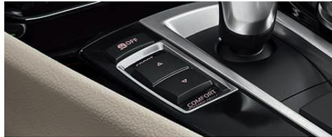
■ **Fahrerlebnisschalter** inkl. **ECO PRO Modus**. Über den in der Mittelkonsole platzierten Schalter aktivieren Sie den gewünschten Fahrmodus. Wechseln Sie vom Modus Comfort mit den Standard-Motor- und Getriebeeinstellungen in den auf Effizienz ausgerichteten ECO PRO Modus oder den Modus Sport, der noch dynamischeres Fahren ermöglicht. Welche Einstellung gerade aktiviert ist, können Sie jederzeit unterhalb des Tachometers sehen.
