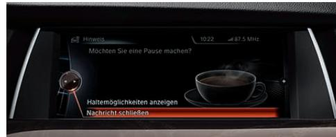
□ **Active Protection** umfasst Sicherheitskomponenten für das Fahrzeug. Bei kritischen Situation werden z. B. Sicherheitsgurte vorgespannt, Sitze in eine aufrechte Position gebracht sowie Fenster geschlossen. Nach einem Unfall kann das Fahrzeug automatisch bis zum Stillstand abgebremst werden. Zudem überwacht der Aufmerksamkeitsassistent das Lenkverhalten des Fahrers und reagiert durch entsprechende Anzeigen im Control Display.
