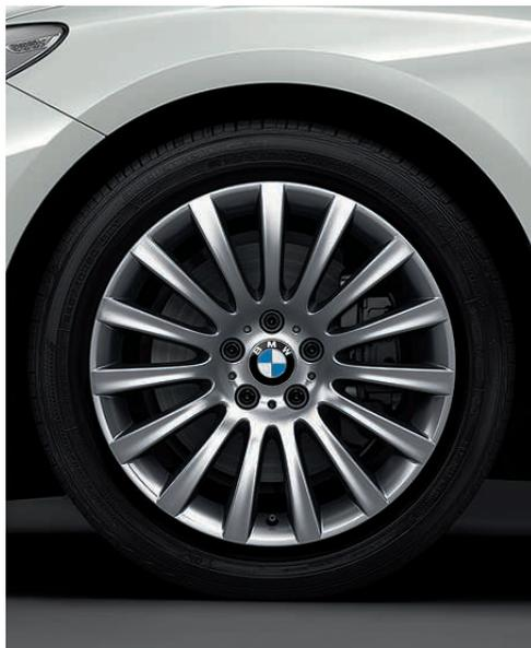
□ **19" Leichtmetallräder Vielspeiche 235** mit Mischbereifung, Größe vorn 8,5 J x 19, Bereifung 245/45 R 19, Größe hinten 9,5 J x 19, Bereifung 275/40 R 19.
