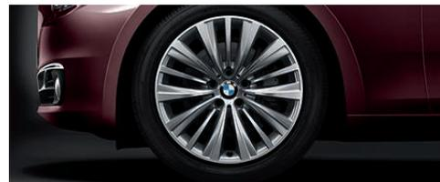
■ **19" Leichtmetallräder Vielspeiche 458** mit Mischbereifung, Größe vorn 8,5 J x 19, Bereifung 245/45 R 19, Größe hinten 9,5 J x 19, Bereifung 275/40 R 19.
