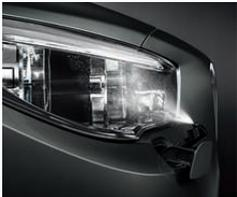
■ **Scheinwerfer-Waschanlage** ermöglicht bei jeder Witterung eine optimale Leuchtkraft der Scheinwerfer. Bei eingeschaltetem Licht werden mit Betätigen der Wischwasserfunktion parallel zur Frontscheibe auch die Scheinwerfergläser automatisch gereinigt.
