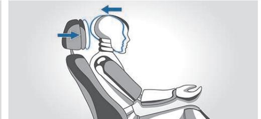
□ **Aktive Kopfstützen vorn** bewegen sich im Falle einer Kollision in Richtung Kopf, um ihn weich aufzufangen. Dadurch wird die Halswirbelsäule nicht überstreckt und so das Risiko eines Schleudertraumas für Fahrer und Beifahrer minimiert (nur in Verbindung mit Komfortsitzen).
