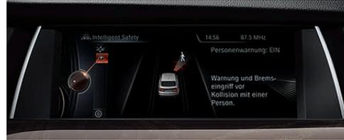
□ **Driving Assistant Plus** umfasst neben Auffahrwarnung und Spurverlassenswarnung auch die Aktive Geschwindigkeitsregelung mit Stop&Go-Funktion sowie den Stauassistenten<sup>1</sup>. Damit steigert Driving Assistant Plus bei Autobahnfahrten die Fahrsicherheit und den Fahrkomfort. Voraussetzung ist das Navigationspaket ConnectedDrive bzw. das Navigationssystem Professional.
