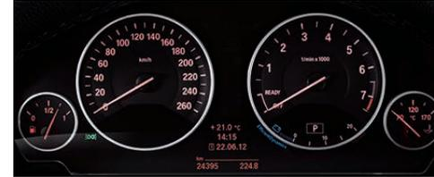
□ **Instrumentenkombination mit erweiterten Umfängen** verfügt u. a. über ein hochauflösendes Info Display zur Darstellung von Funktionen der Check Control, für Navigationshinweise und Bedienrückmeldungen sowie für die Titel- und Quellenanzeige beim Abspielen von Musiktiteln und Telefon-Wahlwiederholungen. Bei eingeschaltetem ECO PRO Modus motiviert die Instrumentenkombination mit graphischen Hinweisen und ECO PRO Tipps zu einer effizienteren Fahrweise.
