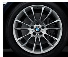
■ **19" M Leichtmetallräder V-Speiche 302 M** mit Mischbereifung, Größe vorn 8,5 J x 19, Bereifung 245/45 R 19, Größe hinten 9,5 J x 19, Bereifung 275/40 R 19.
