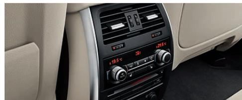
□ **Klimaautomatik mit 4-Zonenregelung** verfügt über die Ausstattung der Klimaautomatik mit 2-Zonenregelung mit erweiterten Umfängen hinaus zusätzlich über Luftausströmer in den B-Säulen sowie eine Komfortdüse in der Instrumententafelmitte für eine gerichtete oder zugfreie Belüftung. Zudem sind die äußeren Sitzplätze im Fondbereich über ein separates Bedienelement mit Display individuell temperierbar (Serie für 550i und 535d).
