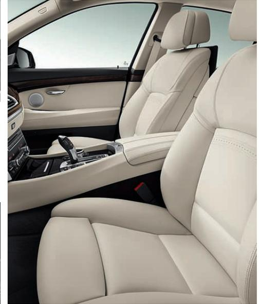
□ **Komfortsitze** für Fahrer und Beifahrer inkl. Aktive Kopfstützen sind vielfach elektrisch verstellbar. So lassen sich das obere Lehnensegment, die Lehnbreite, die Oberschenkelauflage und die Kopfstützenhöhe individuell anpassen. Der Ausstattungsumfang umfasst zudem Lordosenstütze und Memory-Funktion für Fahrer und Beifahrer.
