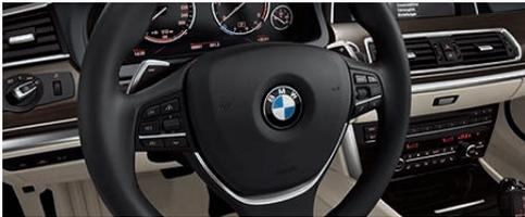
□ **Sport-Lederlenkrad mit Schaltwippen**. Die Gänge können per Schaltwippen am Lenkrad auch manuell gewechselt werden (Schaltwippen nur in Verbindung mit Automatic Getriebe mit Schaltwippen).
