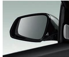
□ **Spurwechselwarnung** erkennt ab einer Geschwindigkeit von 50 km/h bei einem durch Blinkerbetätigung geplanten Spurwechsel ein Fahrzeug im toten Winkel bzw. ein sich auf der Überholspur näherndes Fahrzeug und warnt den Fahrer per Vibration am Lenkrad sowie durch ein optisches Signal im Außenspiegelgehäuse.
