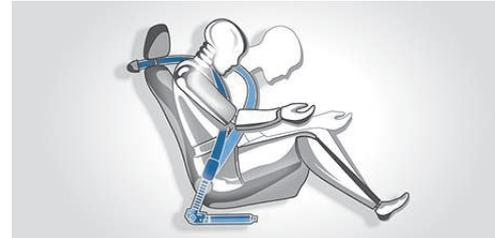
■ **BMW Rückhaltesystem** ist ein wesentlicher Bestandteil im Rahmen der passiven Sicherheit Ihres BMW. Es sorgt im Fall einer Kollision dafür, dass die Gurtschlösser von Fahrer und Beifahrer in Sekundenbruchteilen pyrotechnisch zurückgezogen werden und Schulter- und Beckengurt gleichzeitig gestrafft werden. Dabei wirken 3-Punkt-Sicherheitsgurte, Gurtstrammer und Gurtkraftbegrenzer systematisch zusammen. So ist für bestmögliche Rückhaltewirkung gesorgt.
