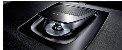
□ **Bang & Olufsen High End Surround Sound System** umfasst 16 Lautsprecher mit 1.200 Watt Musikleistung. Zur herausragenden Akustik trägt die DIRAC-Dimensions-Signalverarbeitung bei. Zum Ausstattungsumfang gehören die beiden Soundoptionen „Studio“ und „Expanded“ sowie die Lichtinszenierung einzelner Lautsprecherblenden.
