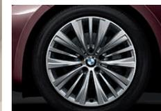
■ 19" Leichtmetallräder Vielspeiche 458 mit Mischbereifung, Größe vorn 8,5 J x 19, Bereifung 245/45 R 19, Größe hinten 9,5 J x 19, Bereifung 275/40 R 19.
