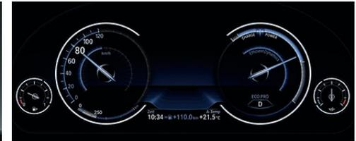
□ **Multifunktionales Instrumentendisplay** in Black-Panel-Technologie und mit 10,2"-Bildschirmdiagonale bietet eine beeindruckende visuelle Inszenierung des Fahrerlebnisses. Drei verschiedene Modi und deren spezifische Merkmale, jeweils farblich und grafisch angepasst, lassen sich in der Instrumentenkombination anzeigen: Modus Comfort, ECO PRO und Sport.
