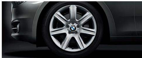
□ **19" Leichtmetallräder Sternspeiche 272** mit Mischbereifung, Größe vorn 8,5 J x 19, Bereifung 245/45 R 19, Größe hinten 9,5 J x 19, Bereifung 275/40 R 19 (Serie für 550i).
