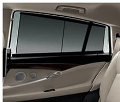
**Sonnenschutzrollo für die hinteren Seitenscheiben** lässt sich elektrisch ein- und ausfahren. Es schützt vor intensiver Sonneneinstrahlung und bietet gleichzeitig einen wirksamen Sichtschutz.
