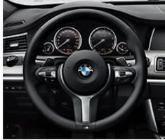
□ **M Lederlenkrad** inkl. Multifunktion besitzt durch stärkere Daumenauflagen und den dickeren Lenkradkranz mehr Griffbarkeit sowie eine sportlichere Optik.
