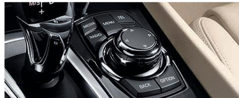
■ **iDrive Controller**, gut erreichbar auf der Mittelkonsole, erlaubt die intuitive Bedienung aller im iDrive System integrierten Funktionen über das zentrale Control Display.
