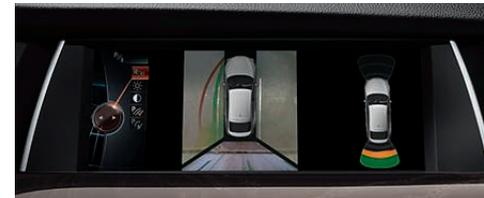
□ **Surround View** enthält die Rückfahrkamera mit Top View sowie Side View und erlaubt so einen 270-Grad-Panorama-Rundumblick: Top View bildet den Tür- und seitlichen Fahrbahnbereich des Fahrzeugs für komfortableres Rangieren ab. Side View ermöglicht bei unübersichtlichen Ausfahrten und Kreuzungen einen frühzeitigen Blick auf den Querverkehr. Die Anzeige erfolgt jeweils im Control Display.
