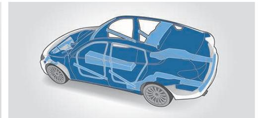
■ **Fahrgastzelle** bietet durch die funktional ausgelegte Struktur mit speziellen Trägerverläufen und Knotenverbindungen sowie den gezielten Einsatz von hochfesten Materialien ein Optimum an passiver Sicherheit im Falle eines Front-, Seiten- und Heckcrashes.
